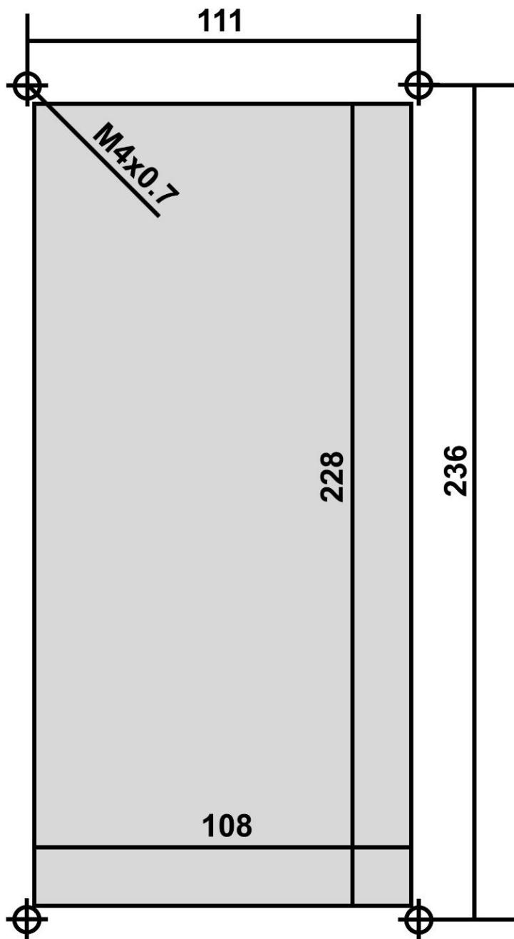
Для обеспечения свободного доступа к интерфейсам USB подключения персонального компьютера и флеш-накопителя, а также RJ-45 подключения к основному блоку, стороннее оборудование рекомендуется размещать на расстоянии не менее 70 мм от левой и нижней границ выреза (относительно стороны лицевой панели ПУ).
