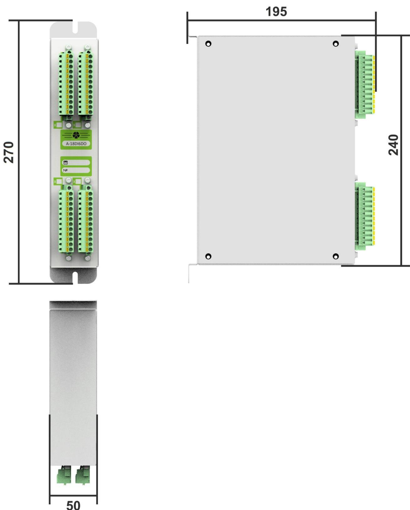
Рисунок П1.2 – Габаритные размеры дополнительного модуля исполнения 01
