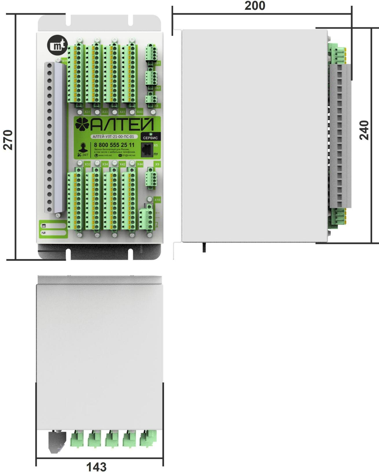
Рисунок П1.1 – Габаритные размеры основного блока Алтей
