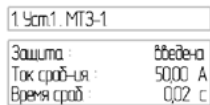
Рисунок 11 – Структурная схема окна настройки защиты МТЗ-1
