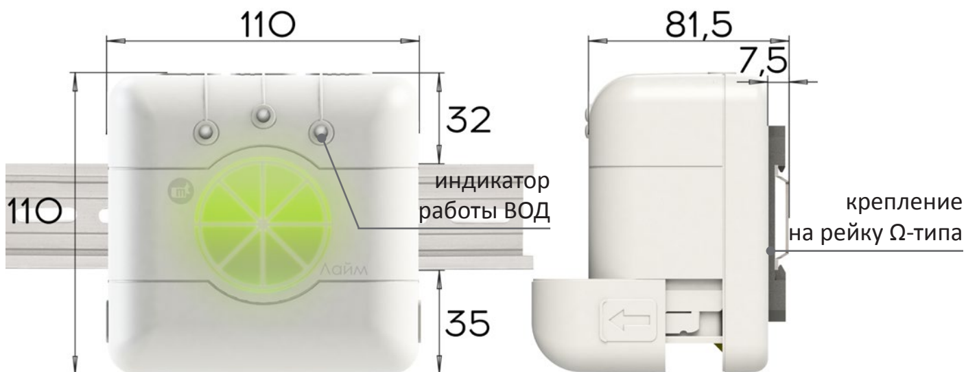
Рисунок 1.5 - Внешний вид и габаритные размеры Лайм
