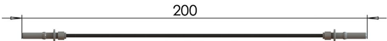
Рисунок 1.7 – Внешний вид и габаритные размеры оптической перемычки
