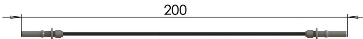
Рисунок 1.7 – Внешний вид и габаритные размеры оптической перемычки
