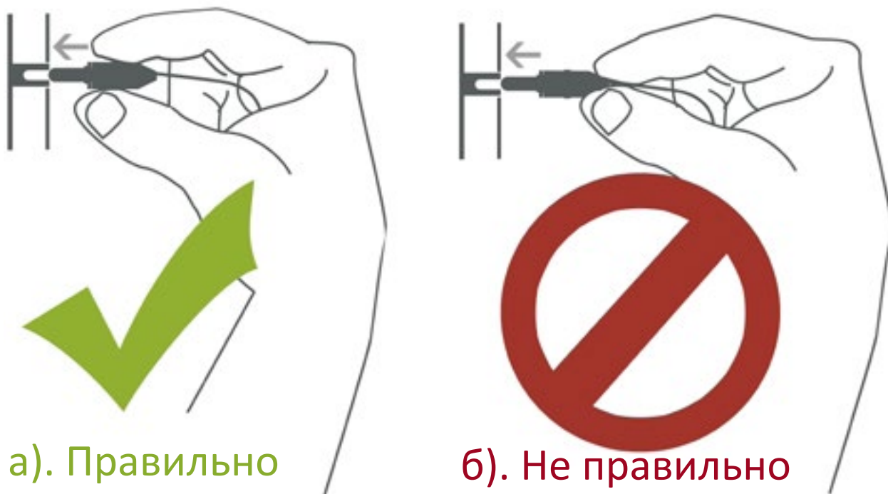
Рисунок 1.8 - Подключение волоконно-оптического кабеля
