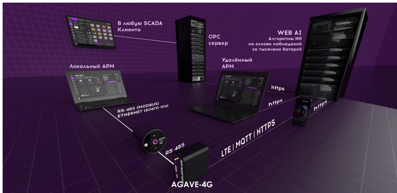
Рисунок 1.1 – структурная схема применения AGAVE-4G
