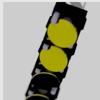
14 механических блинкеров сохраняют своё положение при отсутствии питания
