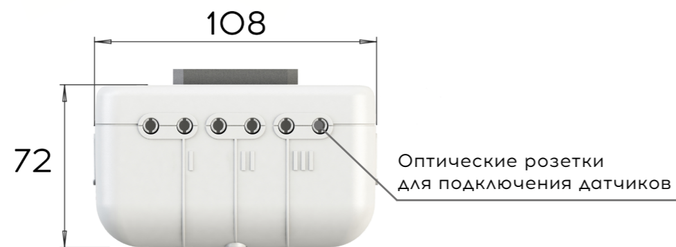
Рисунок 1.13 - Вид сверху и назначение оптических розеток
