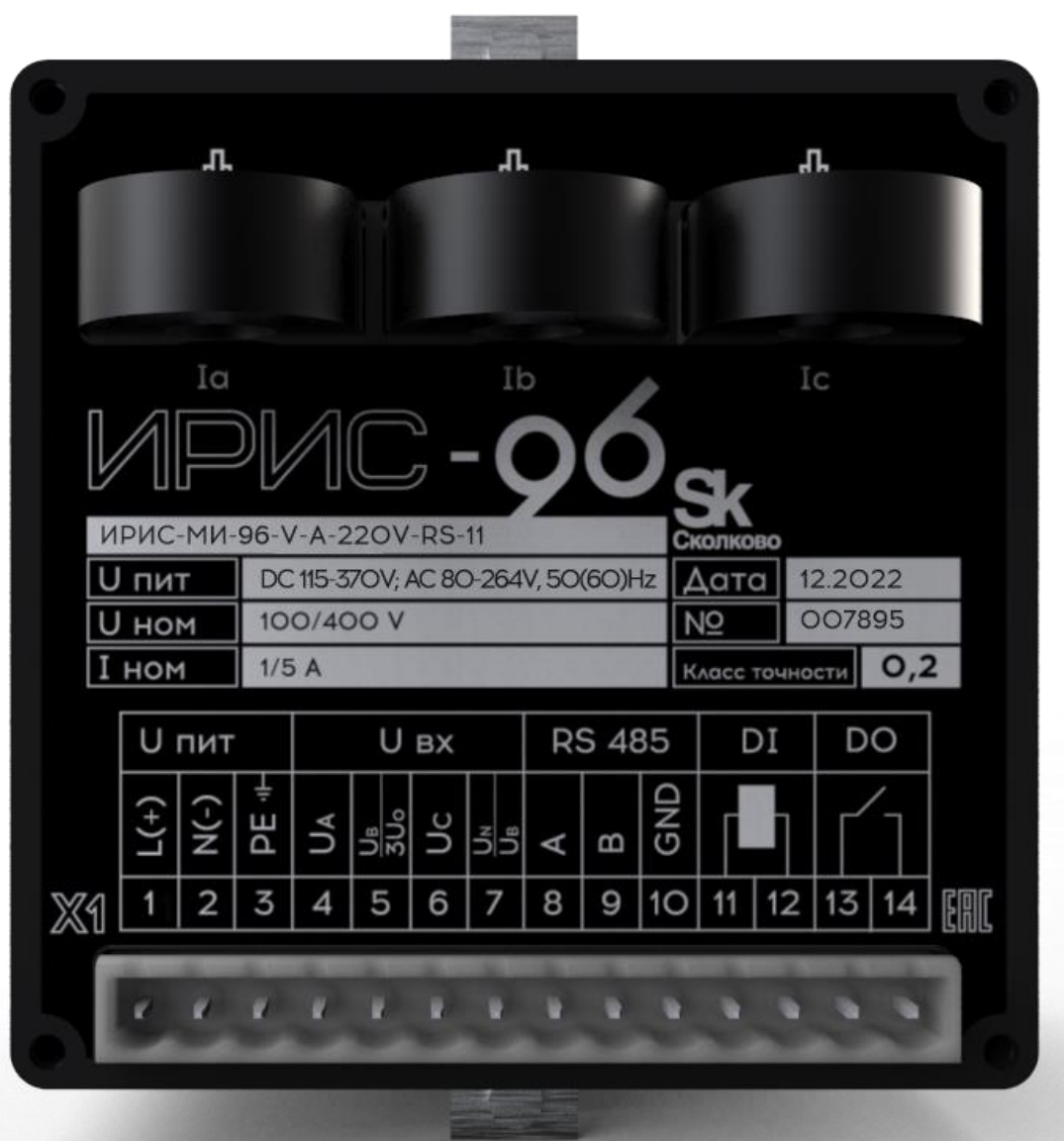
Рисунок 2.3 - Внешний вид задней панели ИРИС
