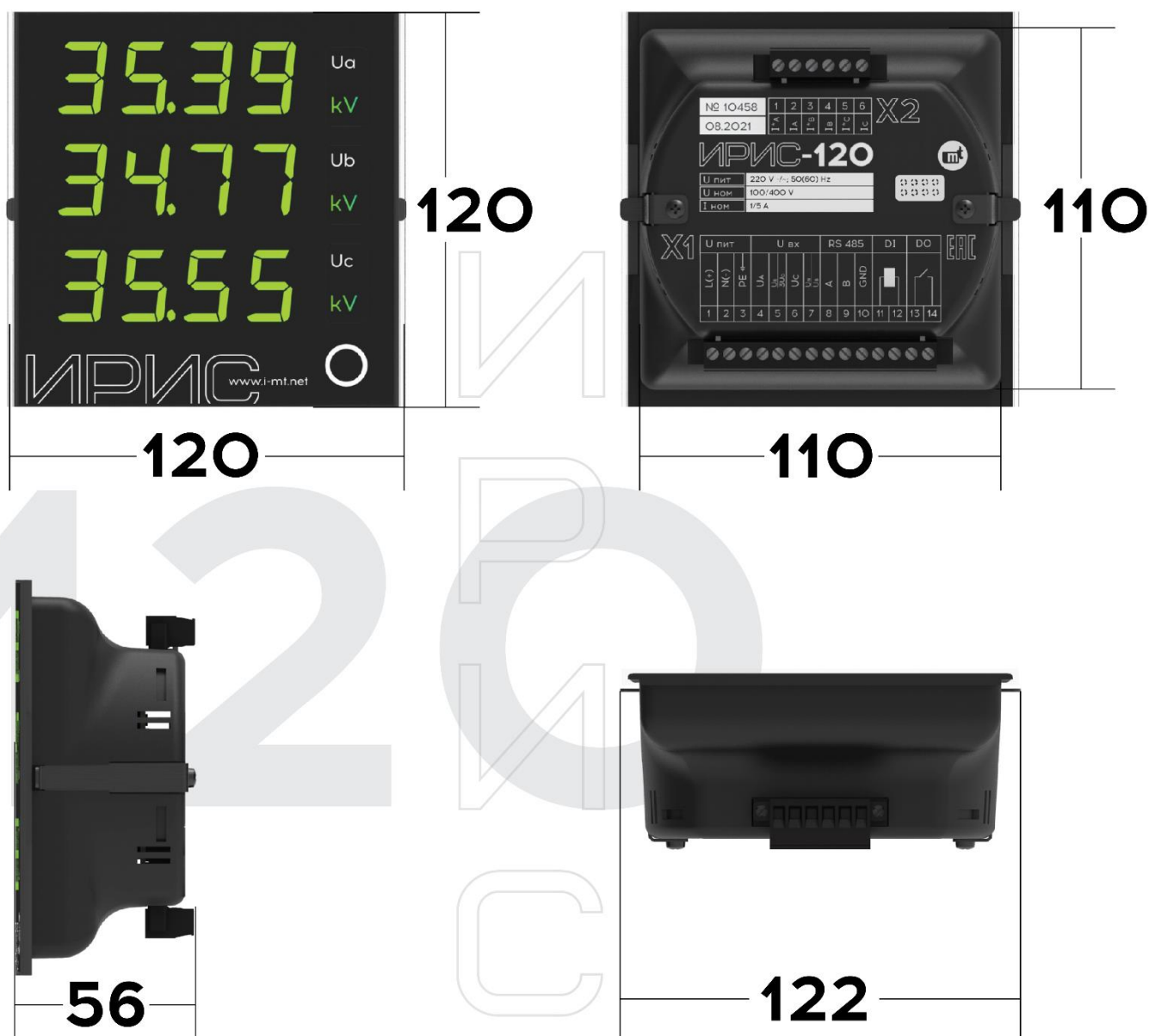
Рисунок 2.2 – Габаритные размеры прибора специального исполнения К (в миллиметрах)
