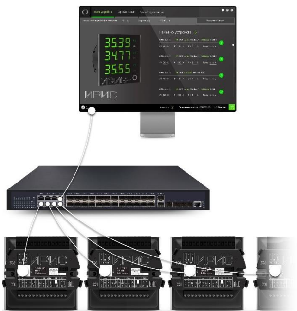
Рисунок 12.5– Схема организации сети Ethernet
