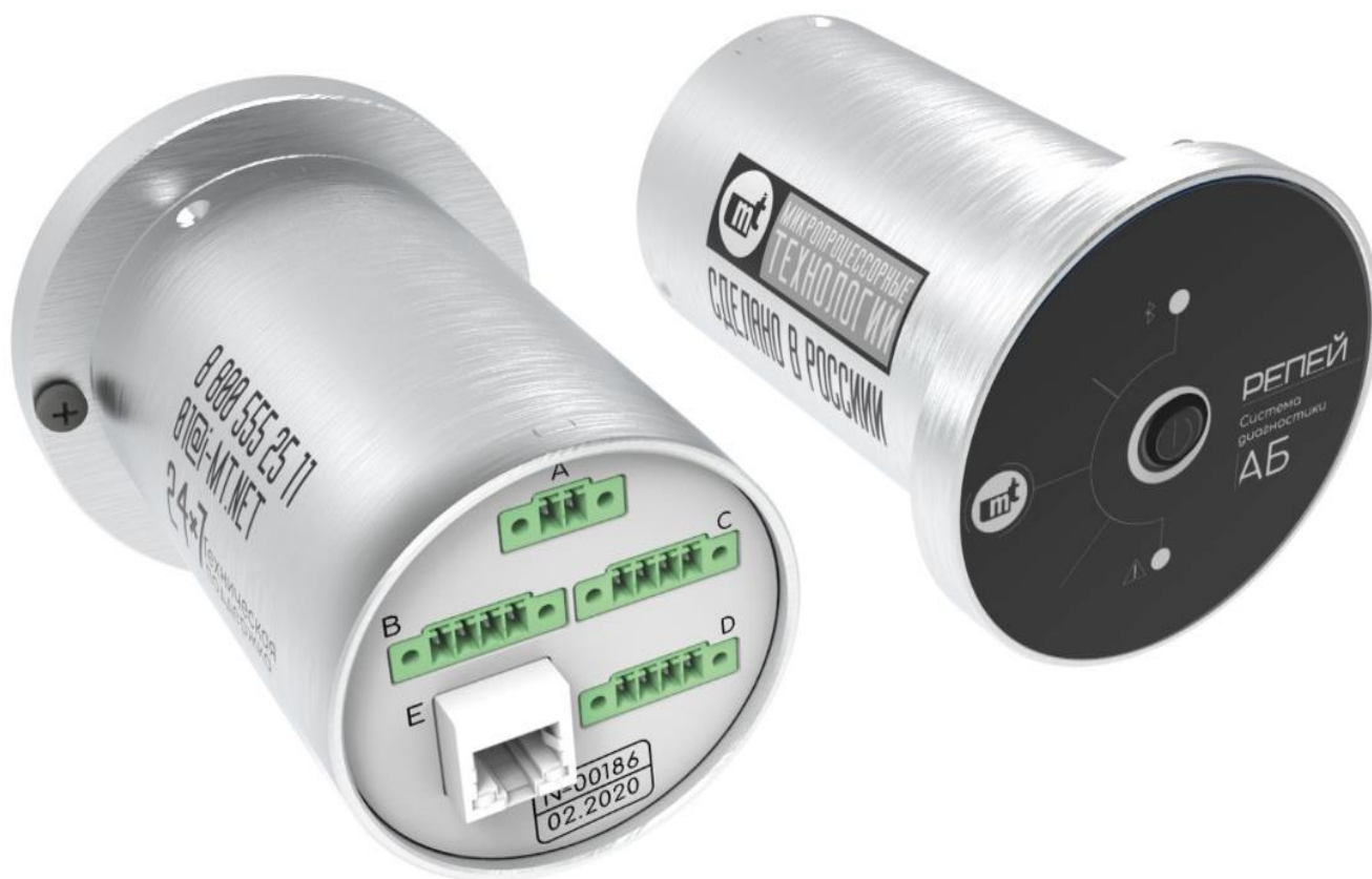
Рисунок 3.1– Внешний вид базовой станции
