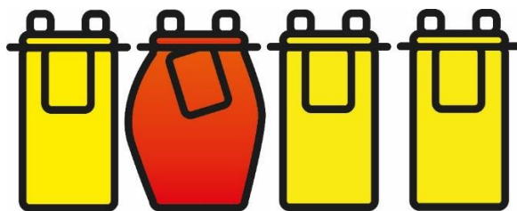
Рисунок 5.10 – Последствия теплового разгона аккумулятора
