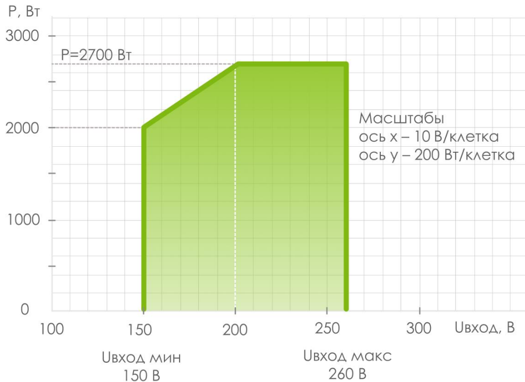
Рисунок 5.4 – Зависимость выходной мощности ЗПУ от входного напряжения
