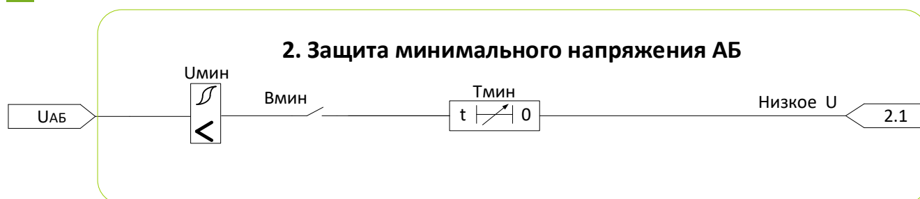
Рисунок 4.2– Алгоритм защиты минимального напряжения АБ
