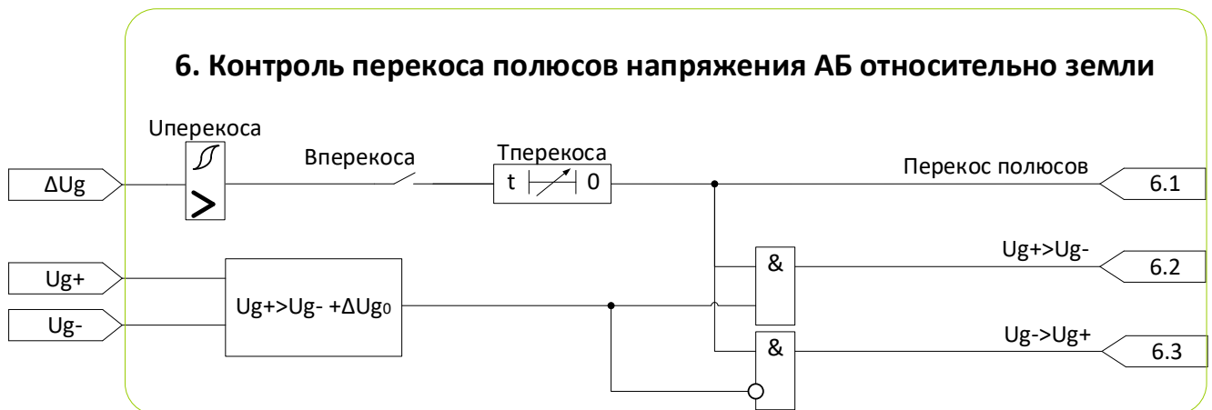
Рисунок 4.7– Алгоритм контроля перекаса полюсов напряжения АБ относительно земли
