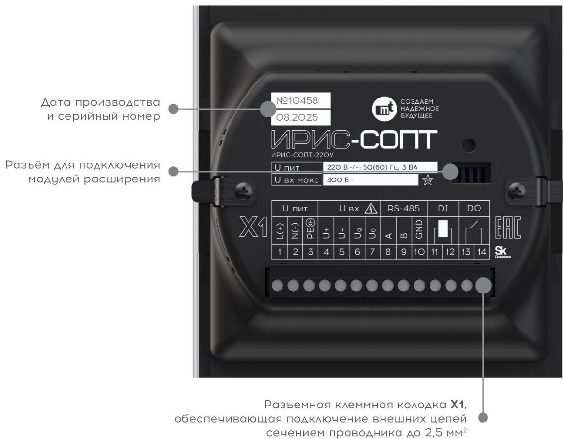
Рисунок 2.4 - Внешний вид задней панели ИРИС-СОПТ
