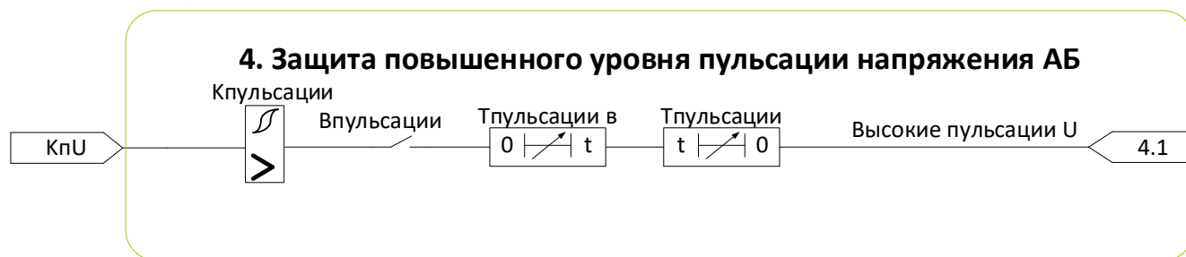
Рисунок 4.4– Алгоритм защиты повышенного уровня пульсации напряжения АБ
