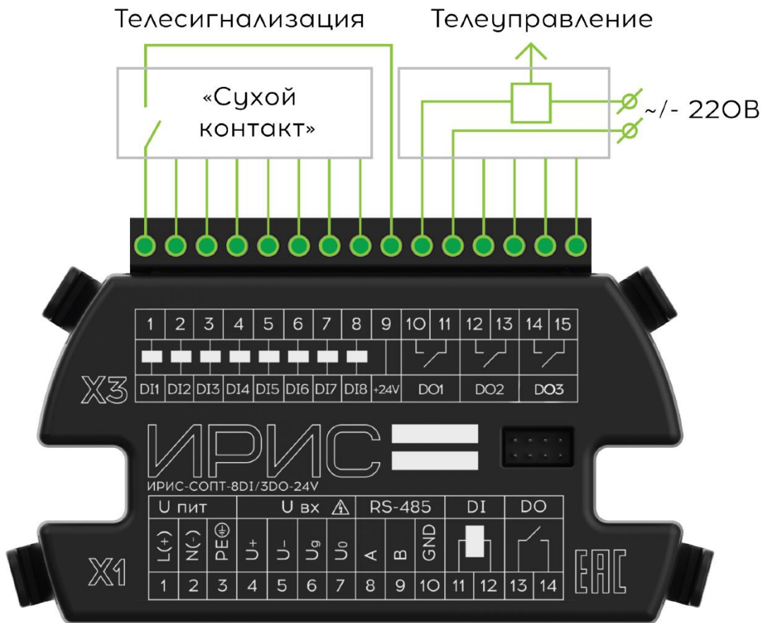
Рисунок 10.5 - Схема подключения рюкзака ИРИС - 8DI/3DO-24V
