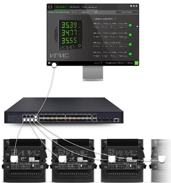
Рисунок 10.4– Схема организации сети Ethernet
