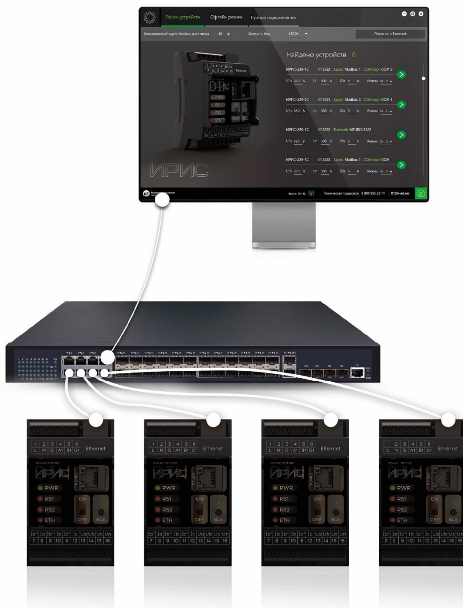
Рисунок 4.4 – Схема организации сети Ethernet
