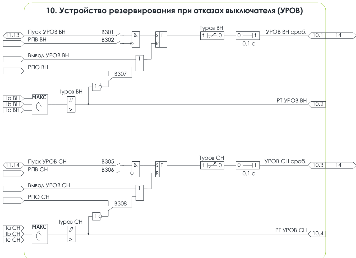
Рисунок 3.14 – Схема №10. Алгоритм УРОВ
