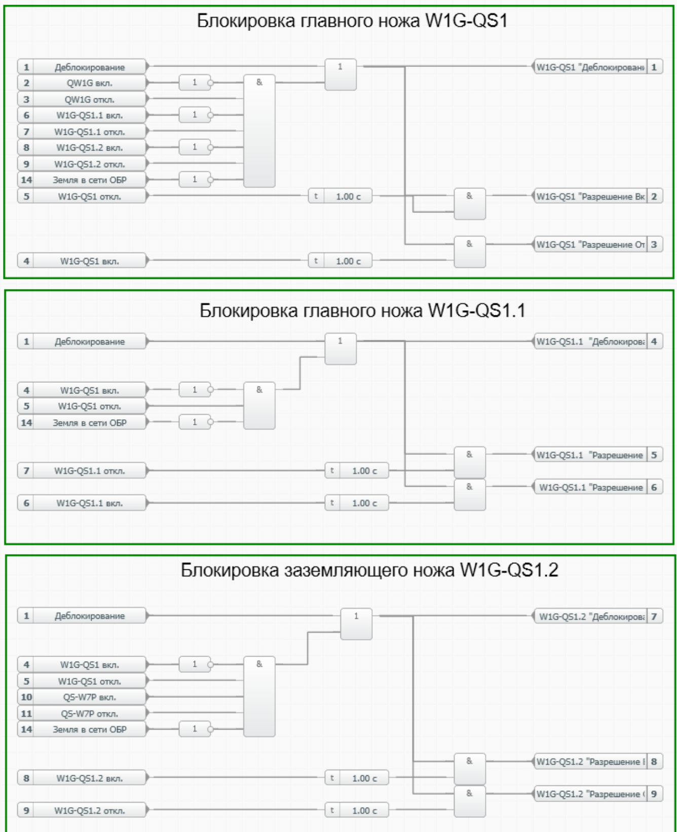
Рисунок 5.1 – Пример логики оперативной блокировки разъединителей, реализованной в KIWI Logic
