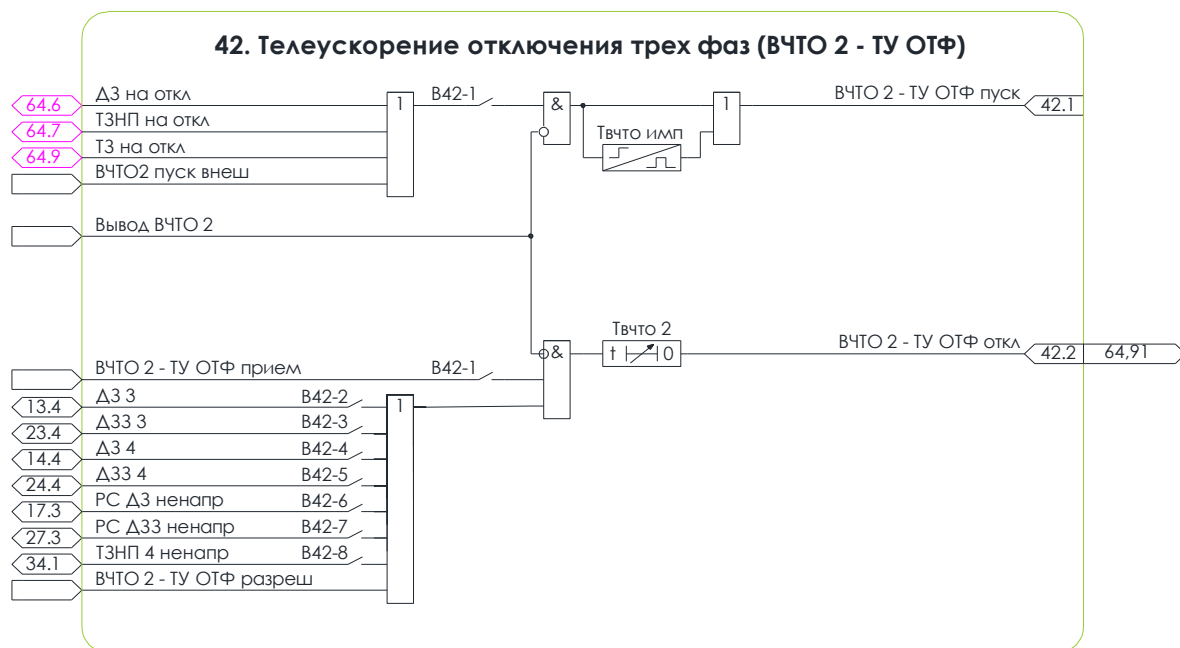
Рисунок 6.2 – Схема №42. Алгоритм ВЧТО 2 – ТУ ОТФ
