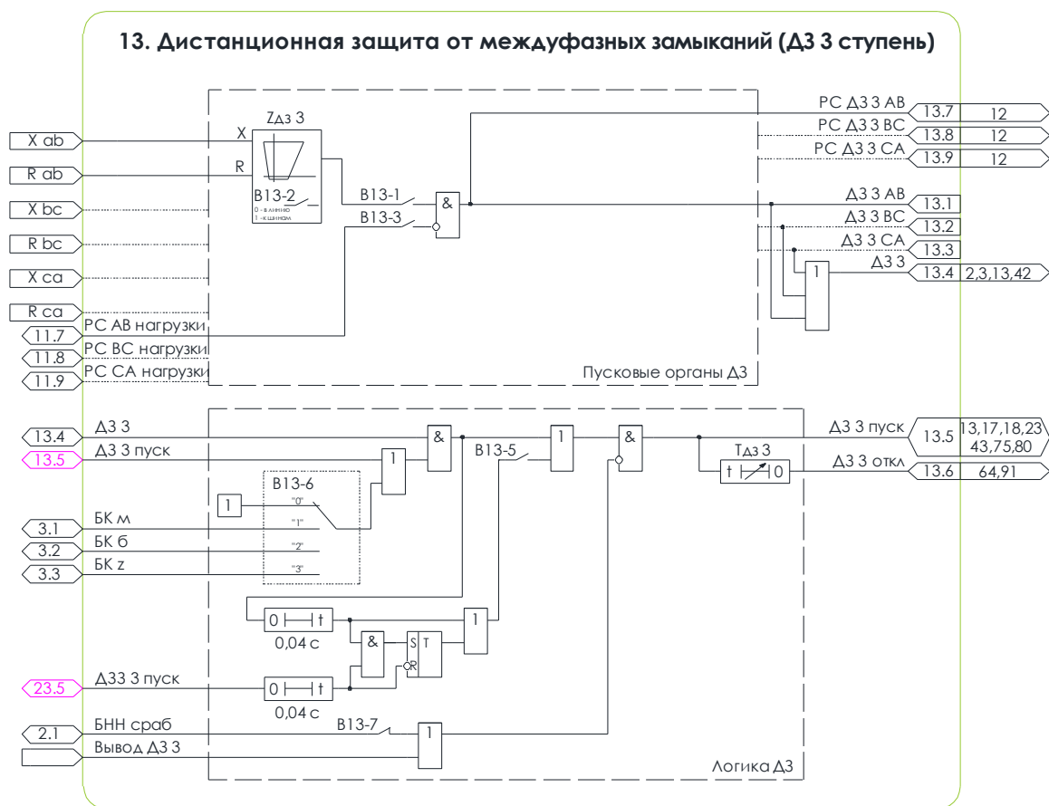
Рисунок 4.23 – Схема №13. Алгоритм третьей ступени ДЗ
