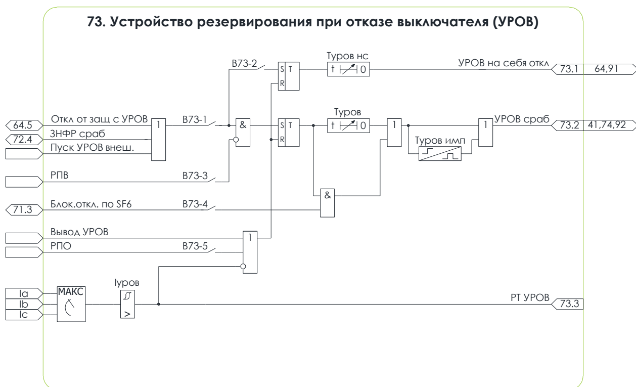
Рисунок 9.3 – Схема №73. Алгоритм УРОВ
