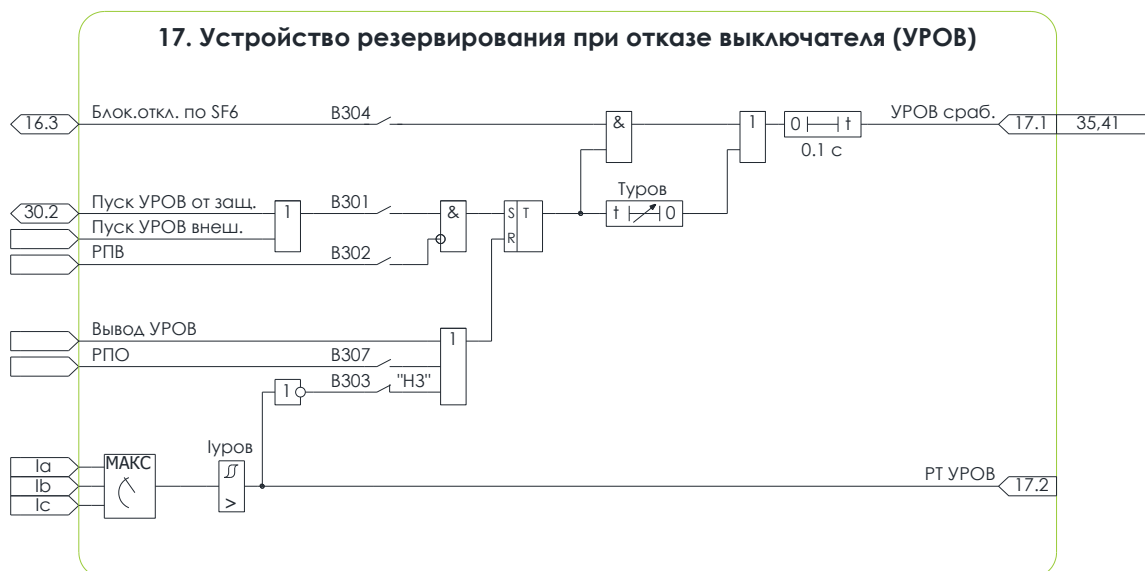
Рисунок 5.17 – Схема №17. Алгоритм УРОВ
