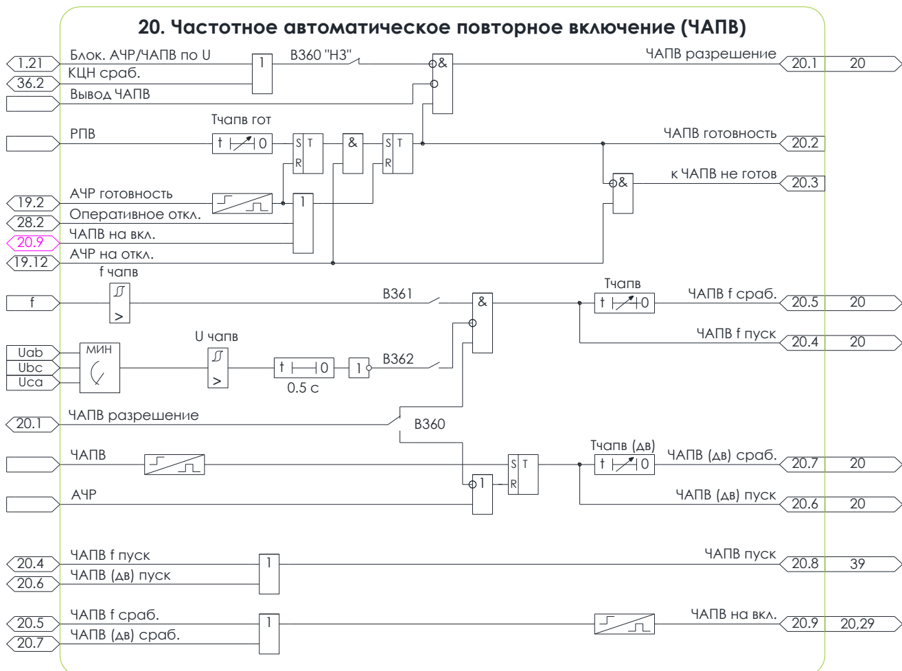
Рисунок 5.19 – Схема №20. Алгоритм ЧАПВ
