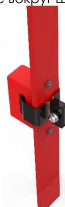
г) Прижать концы ленты друг к другу, обеспечив плотное прилегание к шине/кабелю. Надеть зажим и зафиксировать его, используя винт, шайбу и гровер. Зафиксировать ленту так, чтобы ее концы были заподлицо с зажимом
