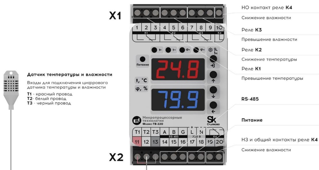
Рисунок 5.1 – Схема подключения реле Флокс-ТВ
