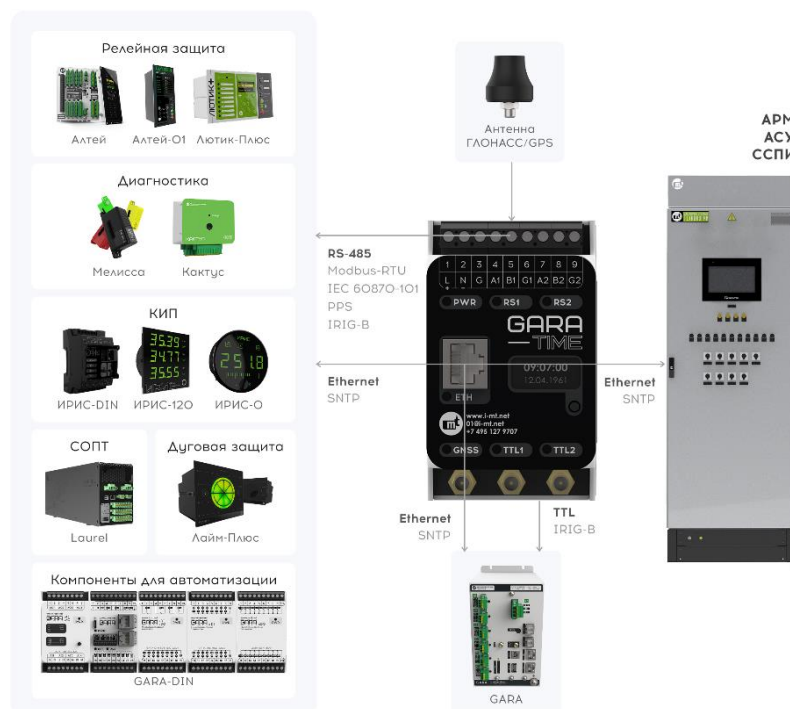
Рисунок 1.1 – Применение GARA-TIME для синхронизации времени различных устройств
