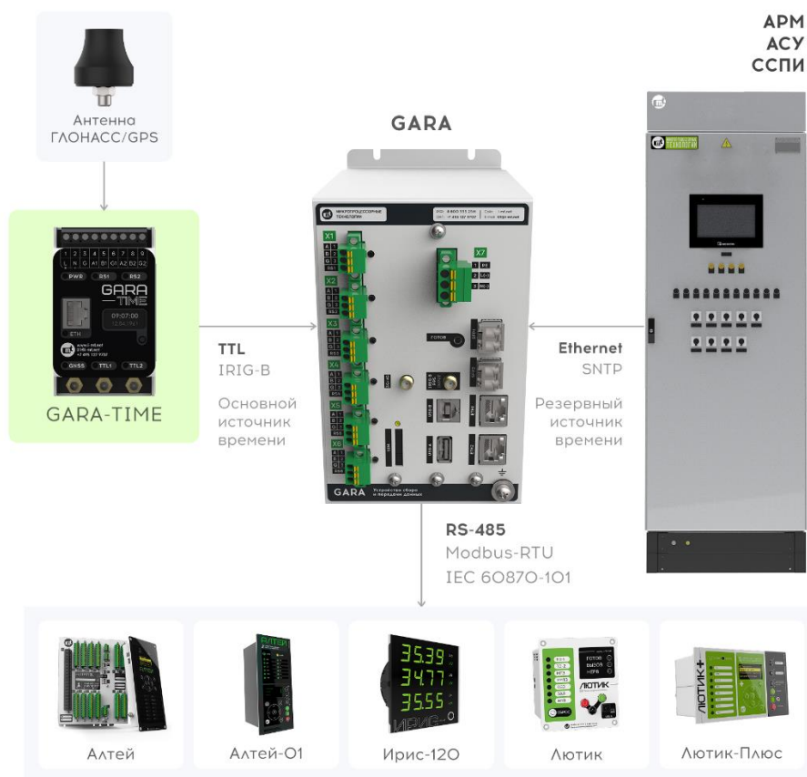
Рисунок 7.2 – Применение GARA-TIME для синхронизации времени GARA по протоколу IRIG-B
