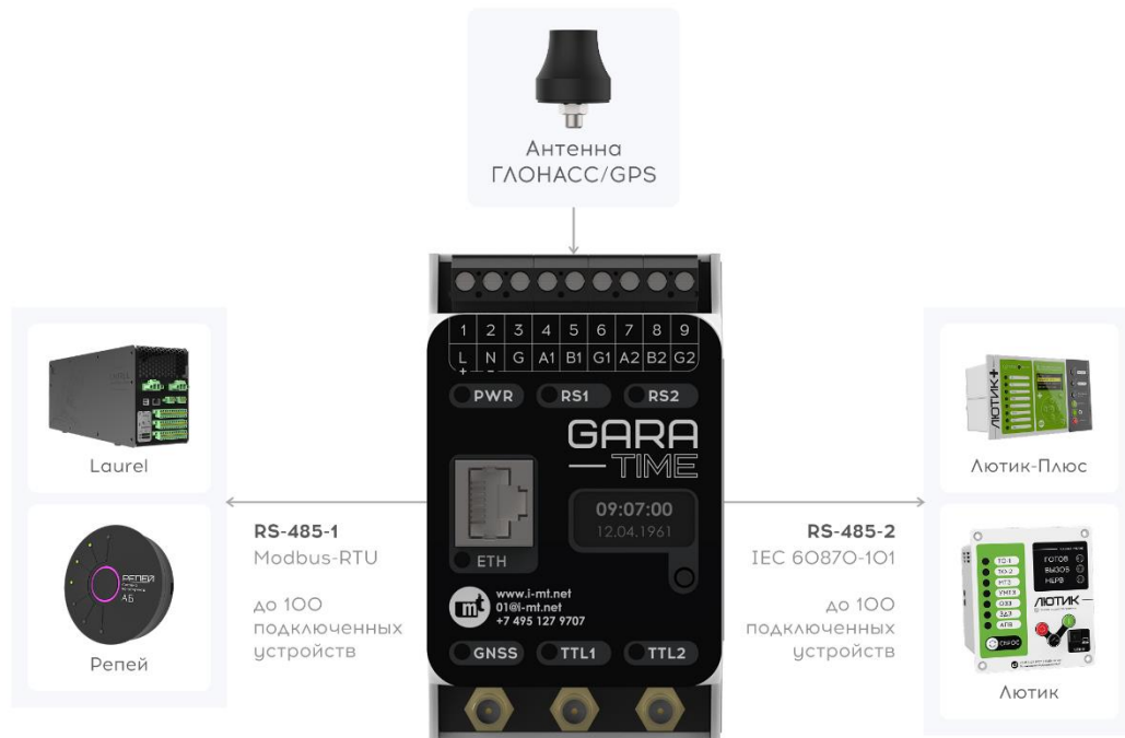
Рисунок 7.1 – Применение GARA-TIME для синхронизации времени устройств по протоколам Modbus-RTU и ГОСТ Р МЭК 60870-5-101-2006
