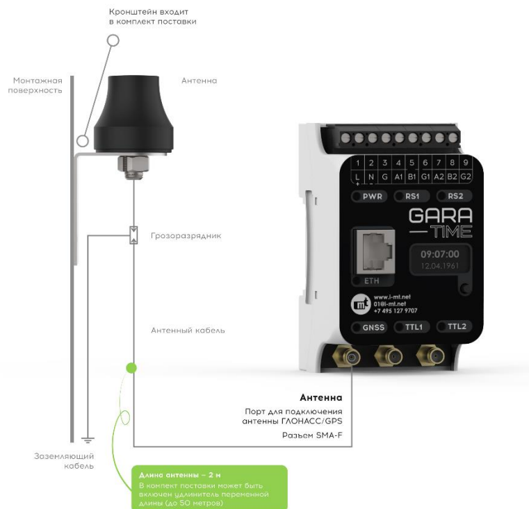
Рисунок 9.2 – Схема установки и подключения антенны
