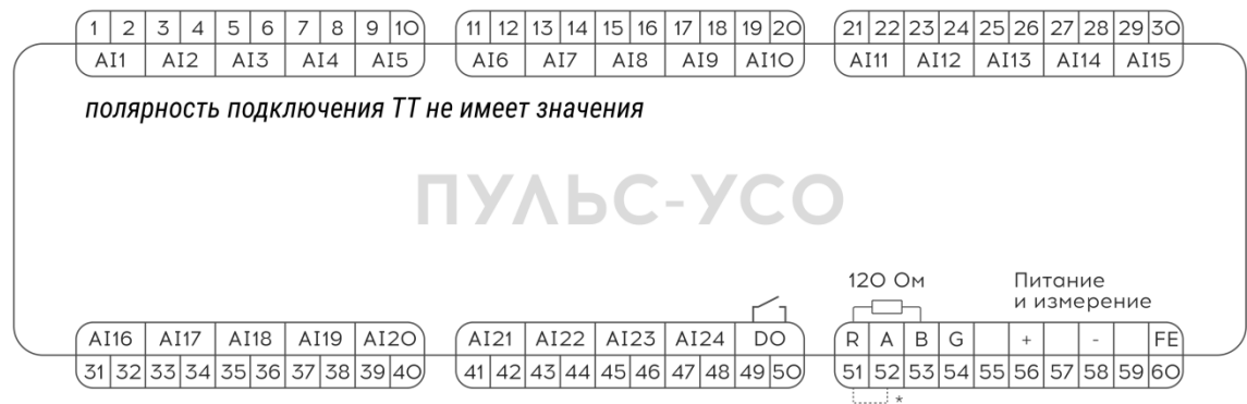
Рисунок В.6 – Схема внешних подключений модуля УСО
