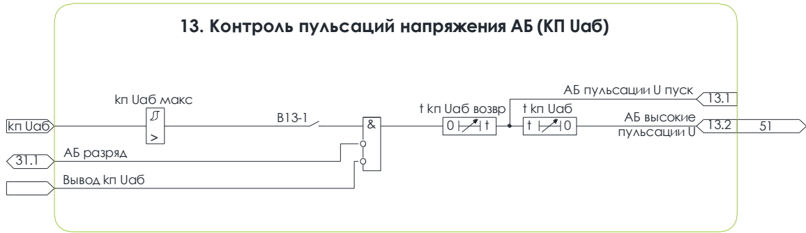
Рисунок 8.10 – Алгоритм контроля пульсаций напряжения АБ
