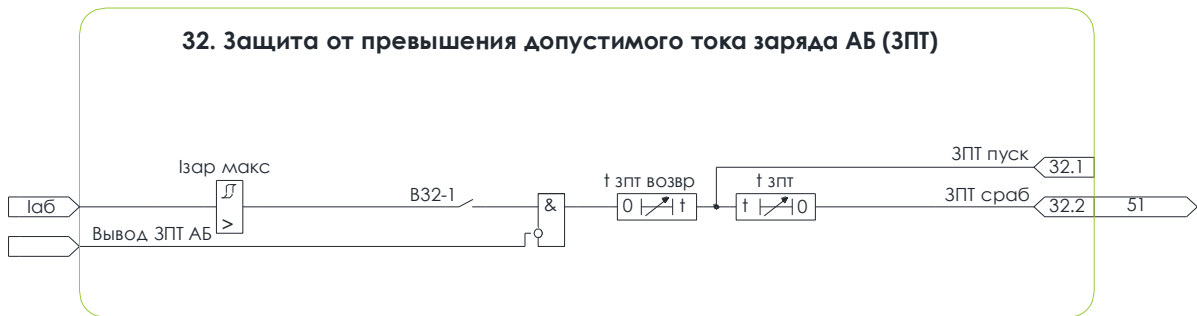
Рисунок 8.18 – Алгоритм защиты от превышения допустимого тока заряда АБ
