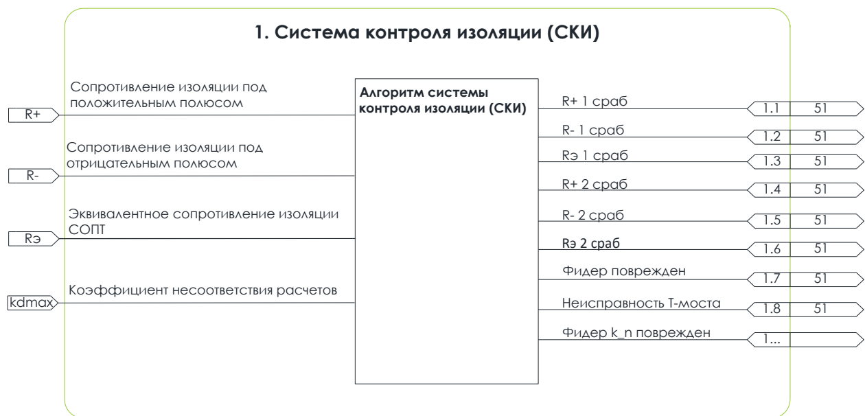
Рисунок 8.6 – Общий алгоритм контроля изоляции
