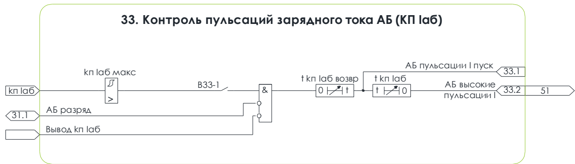
Рисунок 8.19 – Алгоритм контроля пульсаций зарядного тока АБ
