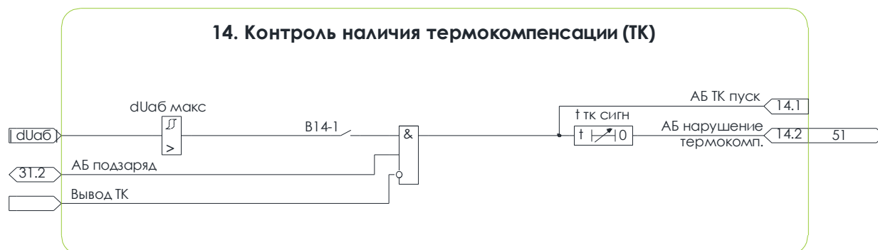
Рисунок 8.11 – Алгоритм контроля термокомпенсации
