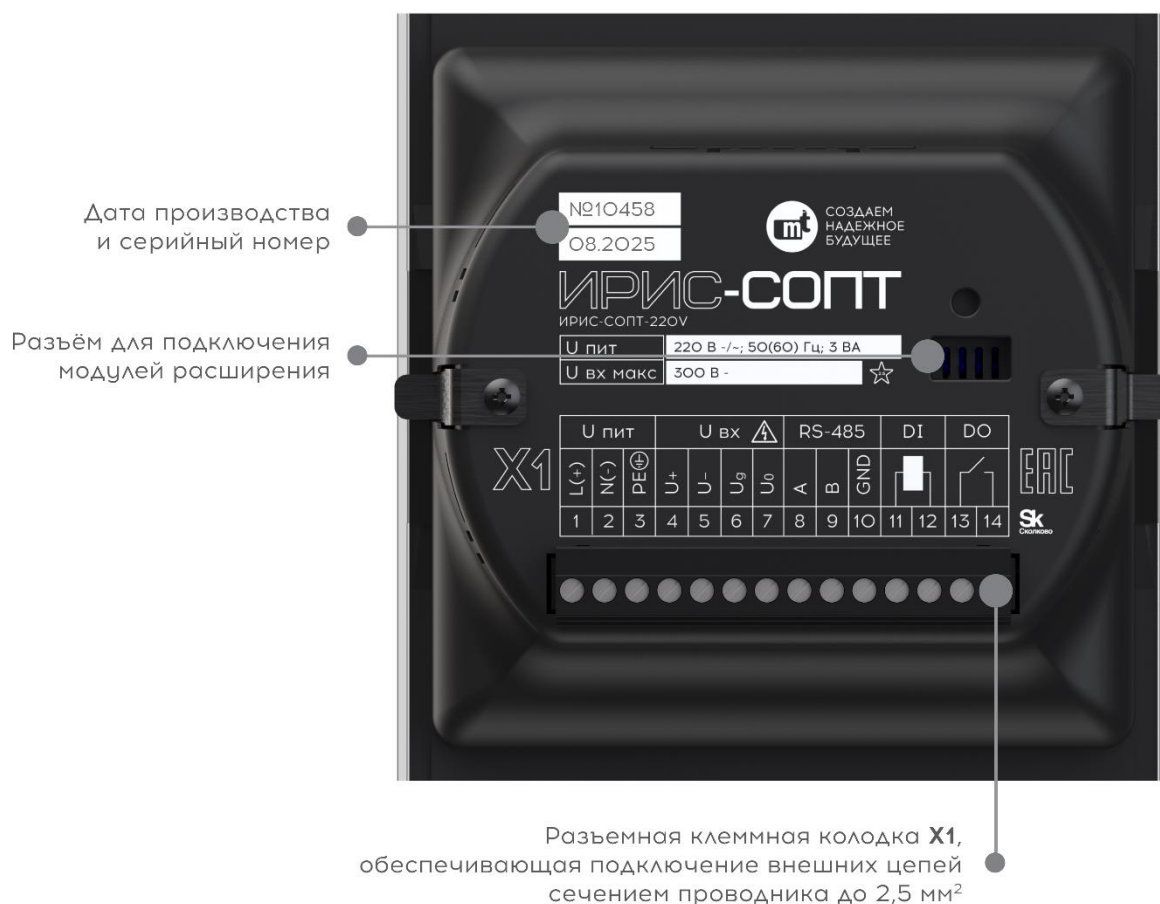
Рисунок 2.4 - Внешний вид задней панели ИРИС-СОПТ
