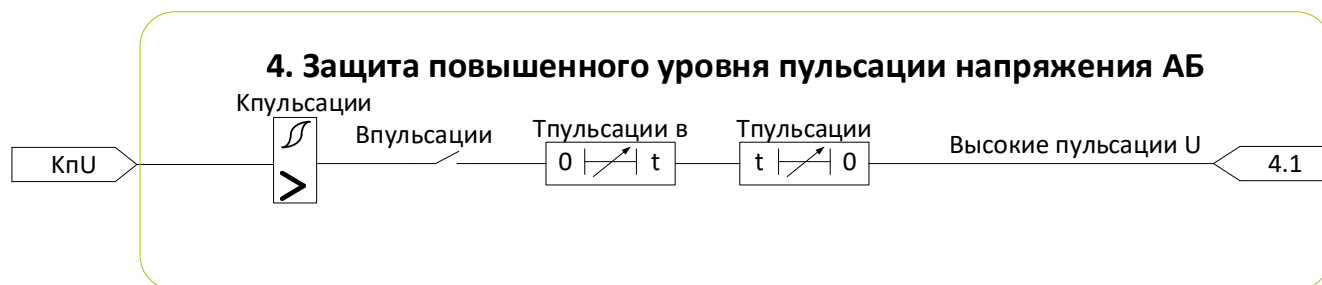
Рисунок 4.4– Алгоритм защиты повышенного уровня пульсации напряжения АБ
