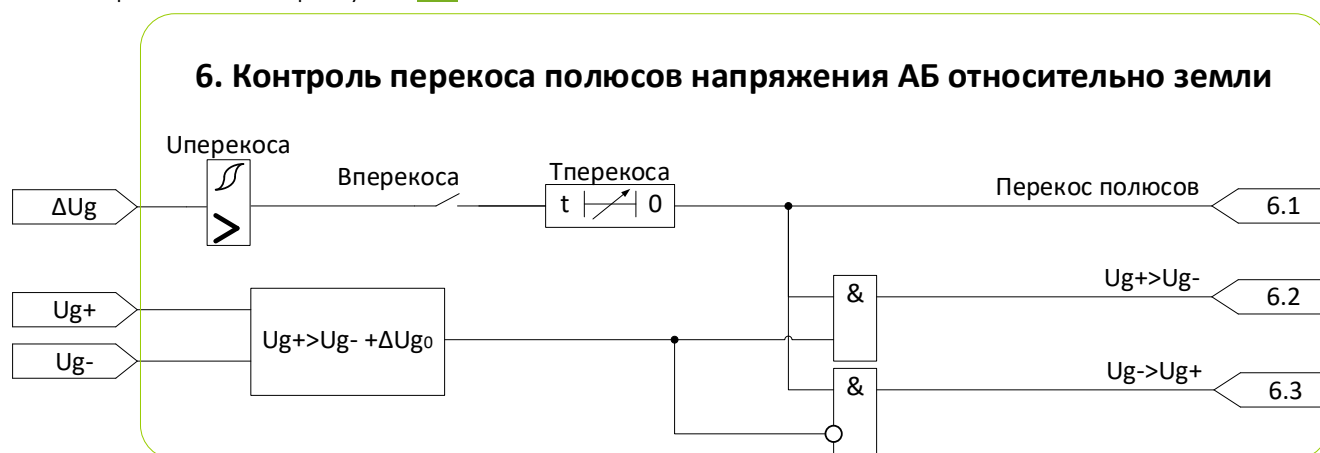
Рисунок 4.7– Алгоритм контроля перекаса полюсов напряжения АБ относительно земли
