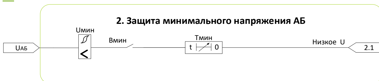
Рисунок 4.2– Алгоритм защиты минимального напряжения АБ
