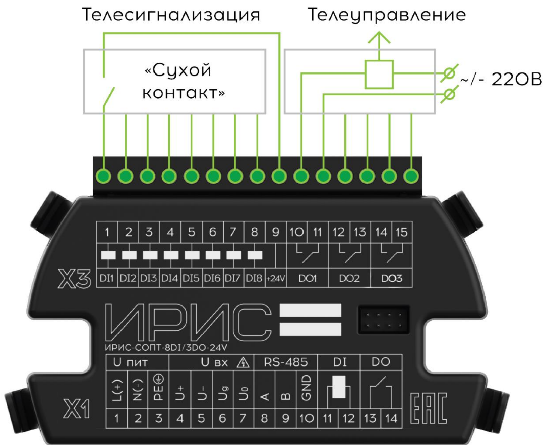
Рисунок 10.5 - Схема подключения рюкзака ИРИС - 8DI/3DO-24V
