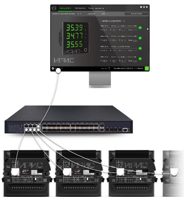
Рисунок 10.4– Схема организации сети Ethernet
