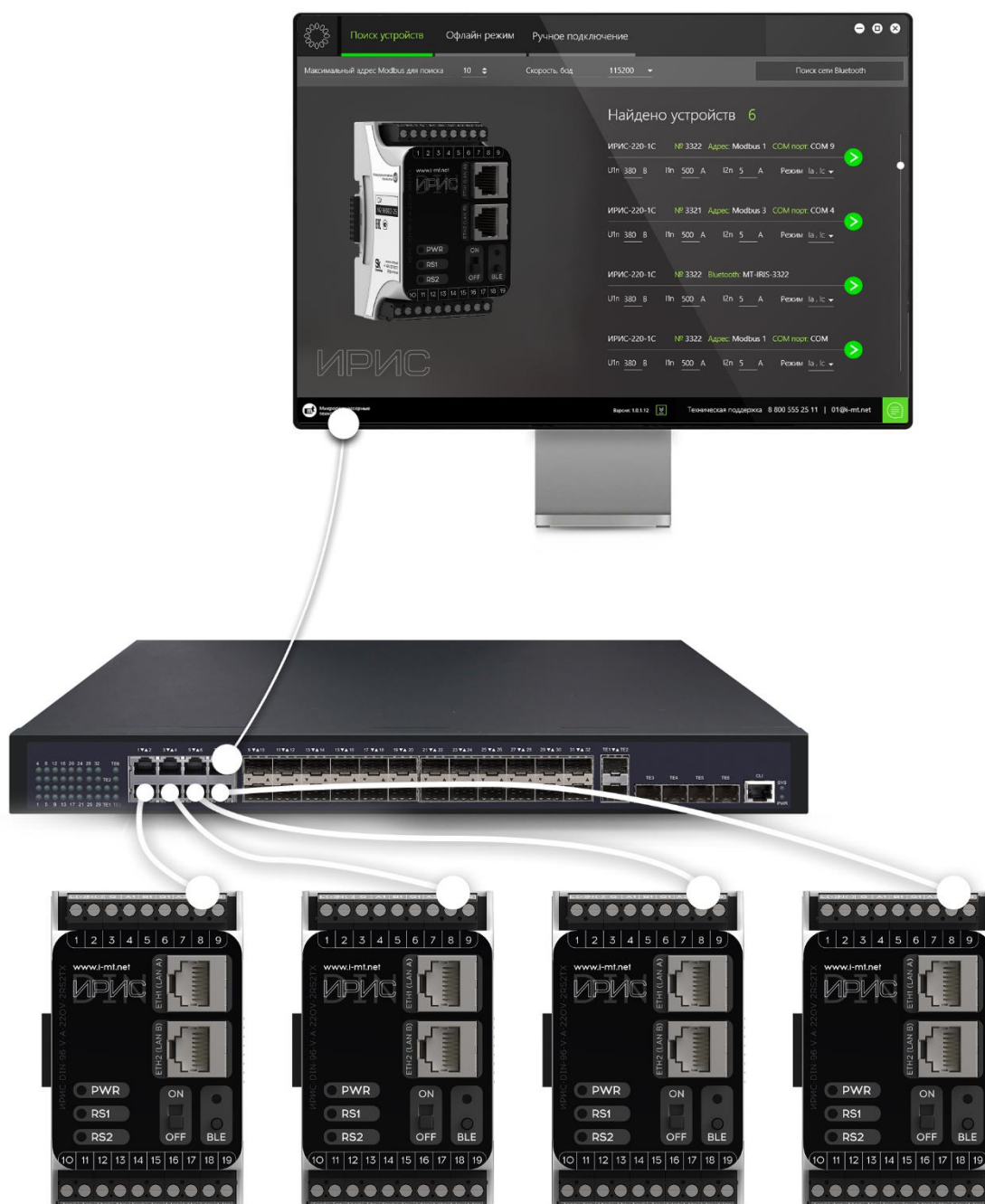
Рисунок 4.4 – Схема организации сети Ethernet
