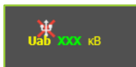
Рисунок 7.3 – Пиктограмма отсутствия связи с устройством-источником данных данного элемента
