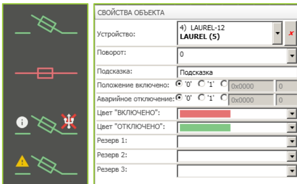
Рисунок 6.41 – Примеры отображения на схеме и окно настройки свойств элемента «Предохранитель»
