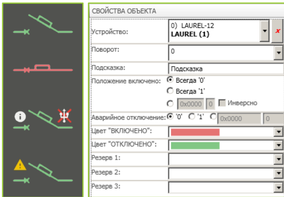
Рисунок 6.40 – Примеры отображения на схеме и окно настройки свойств элемента «Автоматический выключатель»
