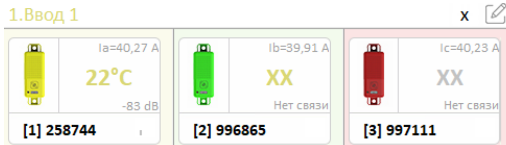
Рисунок 6.20 – KIWI. Настройки Мелиссы. Особенности индикации показаний датчиков
