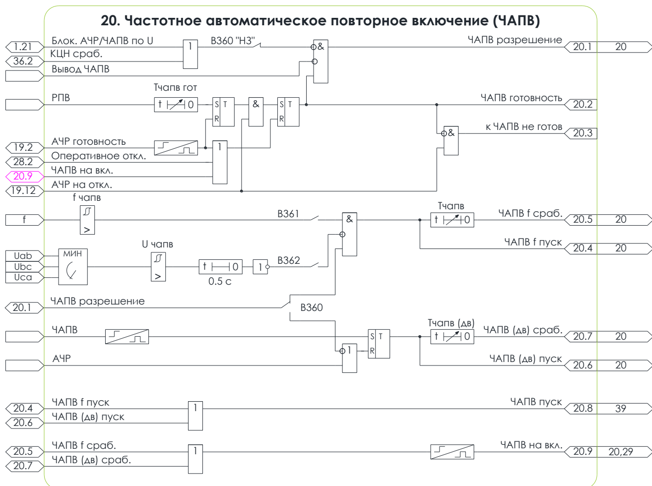
Рисунок 5.19 – Схема №20. Алгоритм ЧАПВ
