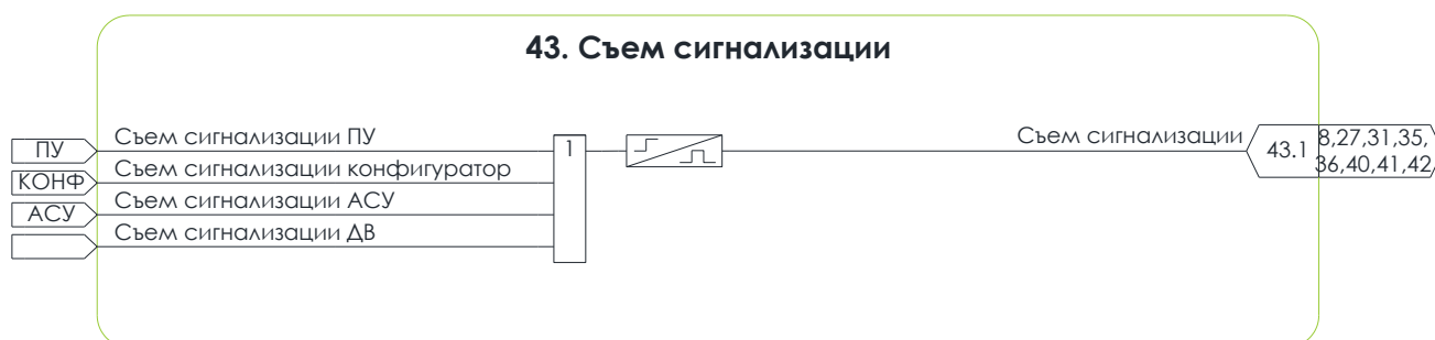
Рисунок 5.43 – Схема №53. Алгоритм съема сигнализации
