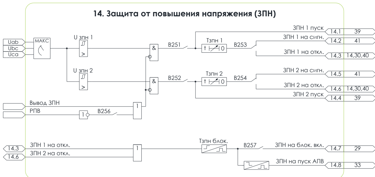
Рисунок 5.14 – Схема №14. Алгоритм ЗПН
