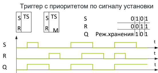
Рисунок П2.1 – Элементы логических схем
