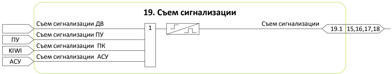
Рисунок 7.24 – Схема №19. Алгоритм съема сигнализации
