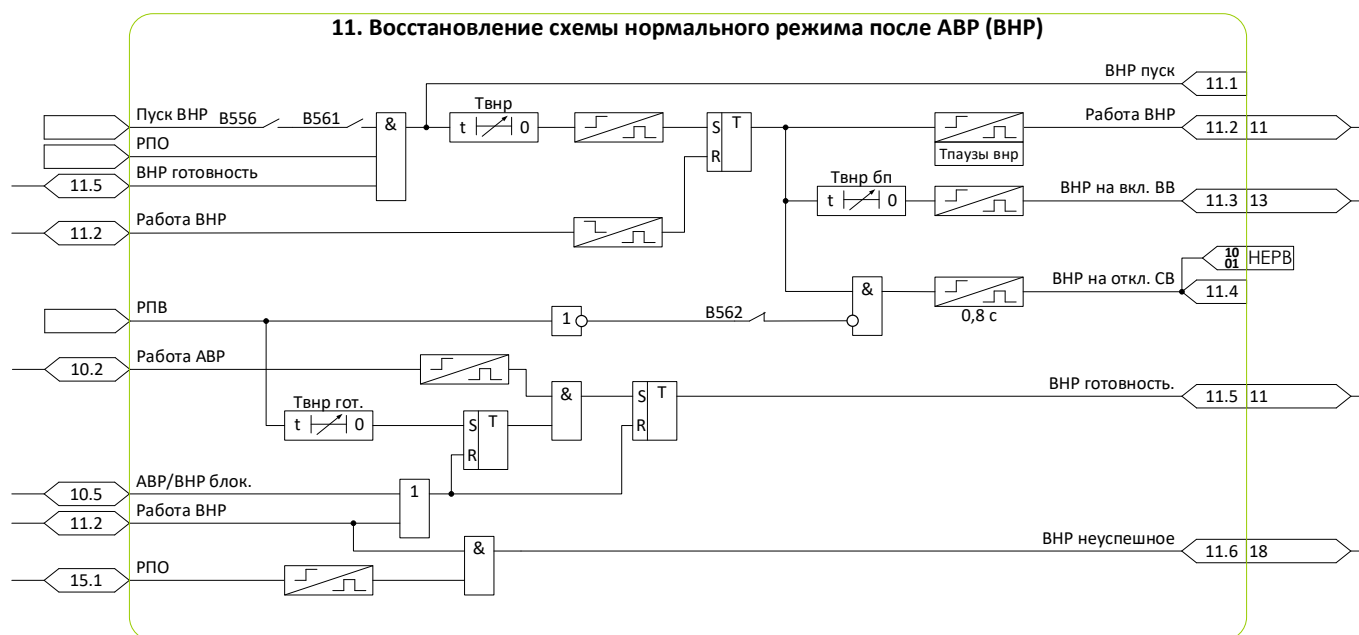
Рисунок 7.15 – Схема №11. Алгоритм ВНР
