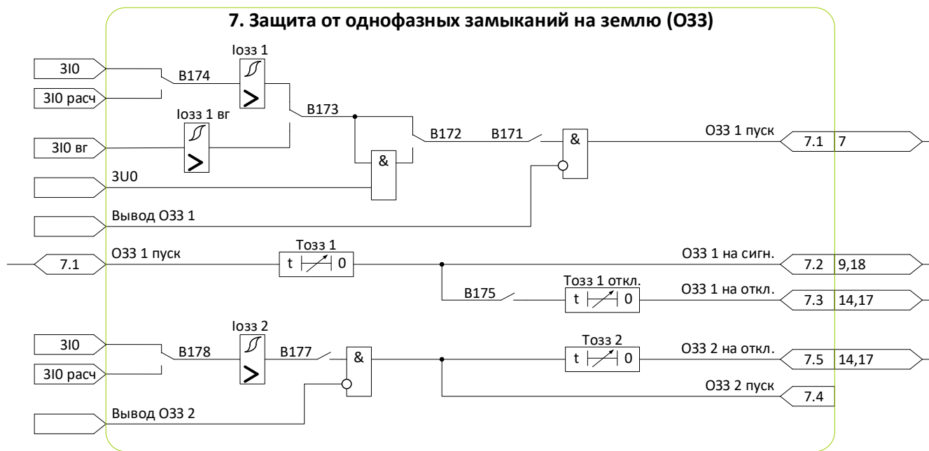
Рисунок 7.10 – Схема №7. Алгоритм ОЗЗ
