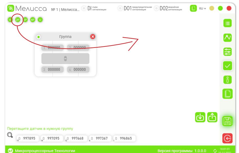
4. Подайте питание на датчики через разъем micro USB. Датчики будут автоматически обнаружены базовой станцией. Перетащите их на соответствующие места в группе.
