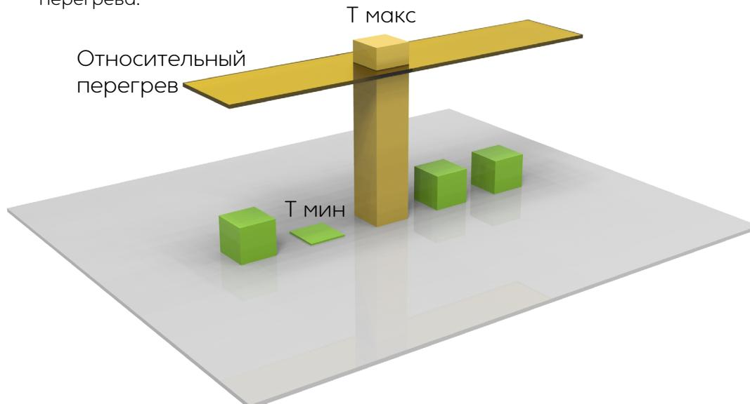
Алгоритм позволяет определить нагревание какого-либо датчика на фоне других, объединенных с ним в группу. При превышении разницей температур самой нагретой и самой холодной точек контроля в группе уставки «Относительный перегрев», с задержкой времени формируется триггерный выходной сигнал «Группа  $m$  – Относительный перегрев», вызывающий предупредительную сигнализацию.
