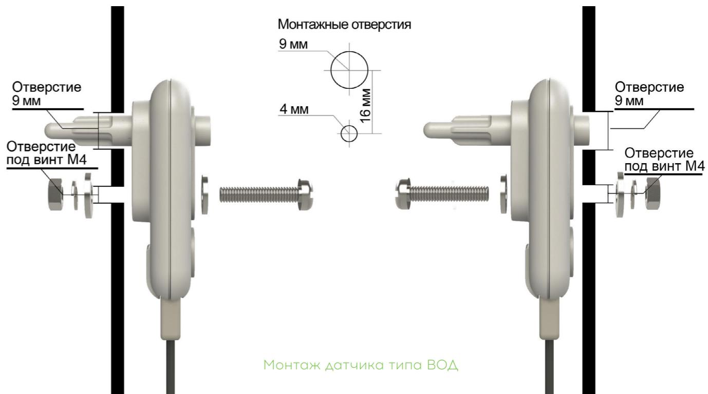
Монтаж датчика типа ВОД
