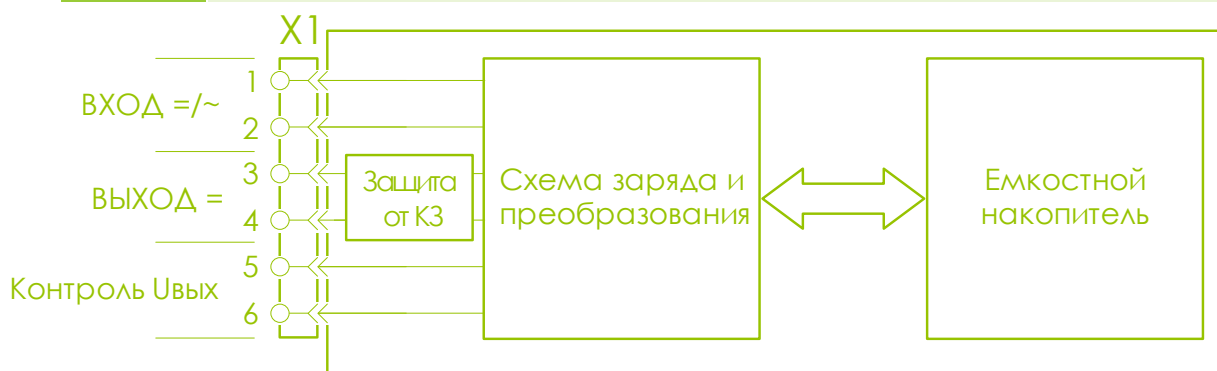
Рисунок 3.1 – Внешние цепи и внутренняя структура блока
