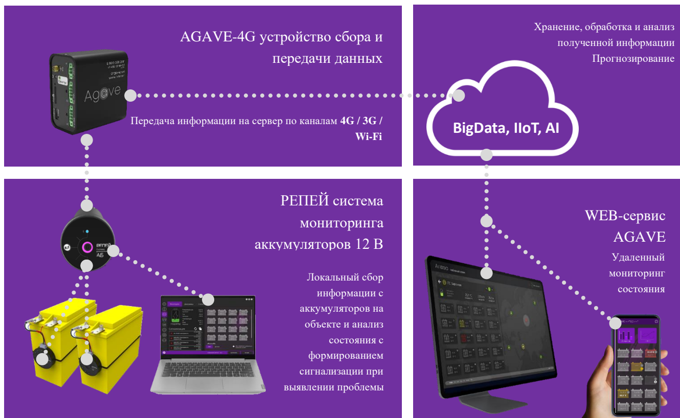
Рисунок 1.1 – структурная схема системы РЕПЕЙ
